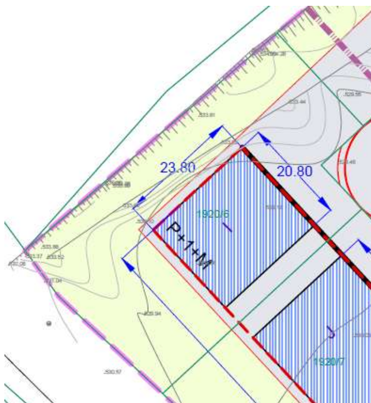
Slika 3: Območje pozidave zemljišča I: parc. št. 1920/6 k.o. 1711 Turjak
